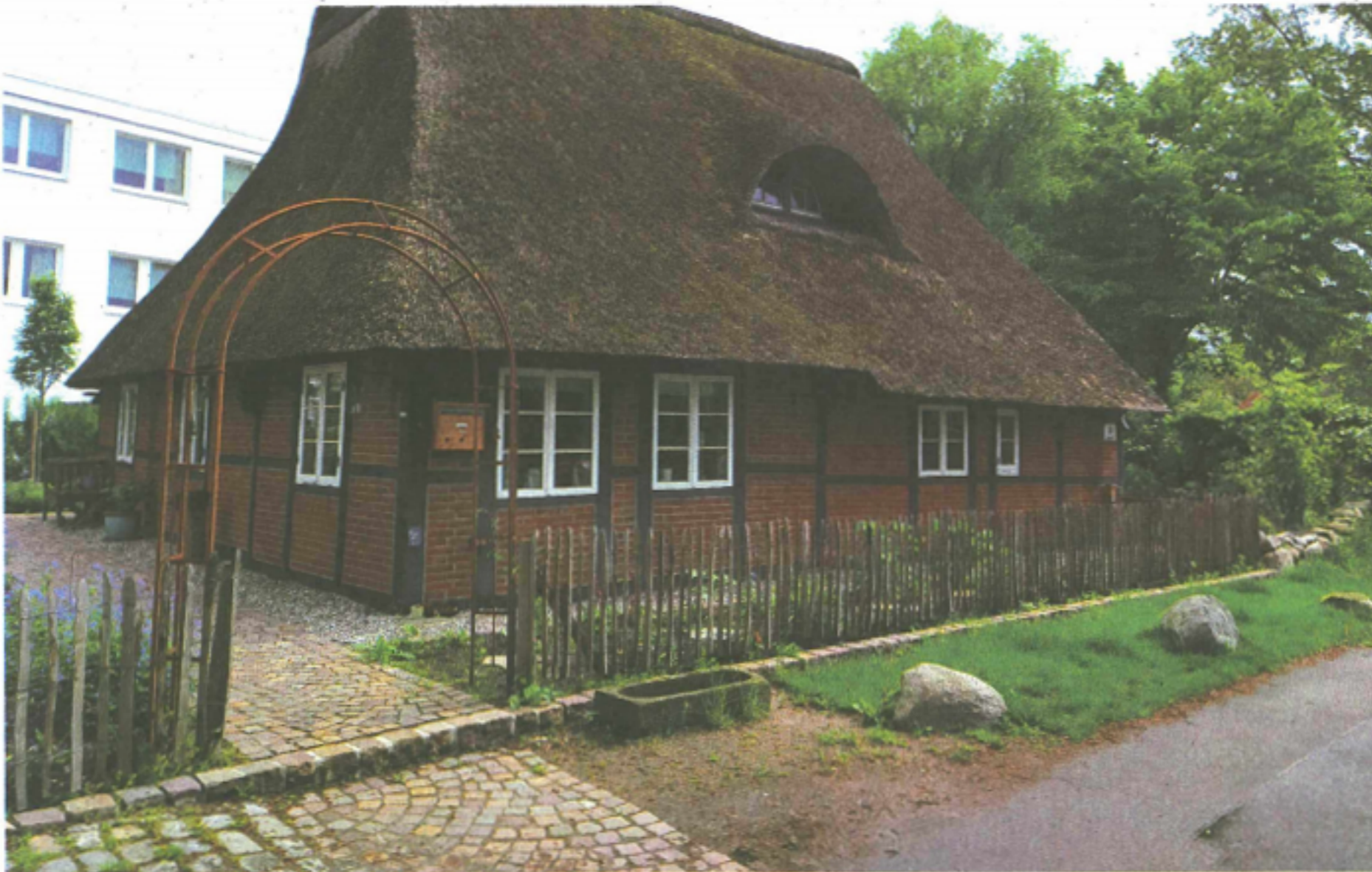
Gebäude, Pflanzen und Pflaster ergänzen sich optisch zu einer Einheit: Kleine Natursteine wurden in dem neu gestalteten Garten im klassischen Segmentbogenmuster verlegt – auch antike Elemente wie Holzzäune und Steinwälle gehören dazu
